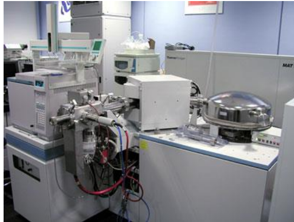
Figura 2.11. Sistema HRGC/HRMS con analizzatore a doppia focalizzazione.
