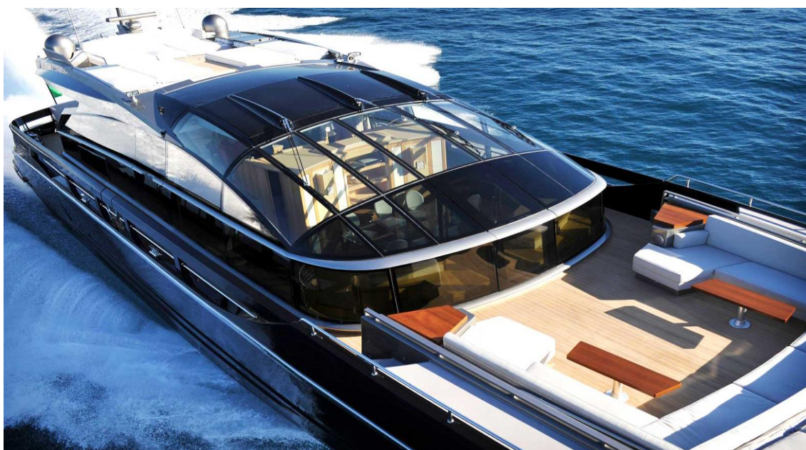
Figura 14. Dettaglio del Baia One Hundred che mostra il pozzetto di prua e l'hard top in vetro 106 .
