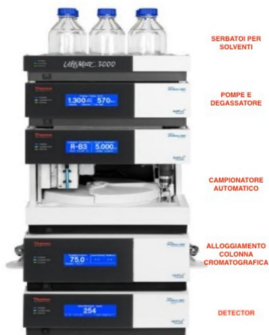
Figura 3.1: Sistema cromatografico Ultimate 3000 UHPLC (Thermo Scientific TM ).
