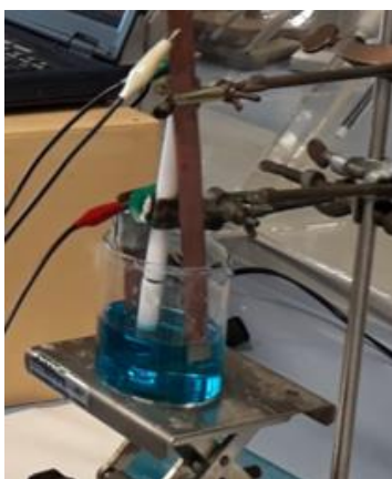
Figura 2.13: Cella elettrochimica a tre elettrodi impiegata per le deposizioni.
