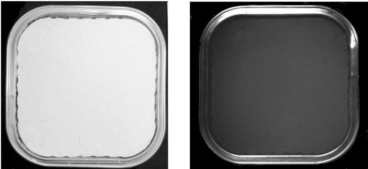
Fig. 13: Acquisizione nel visibile (in scala di grigi) acquisizione nel medio infrarosso con IR-M700 e filtro BP a 4300 nm del provino 06 B.
