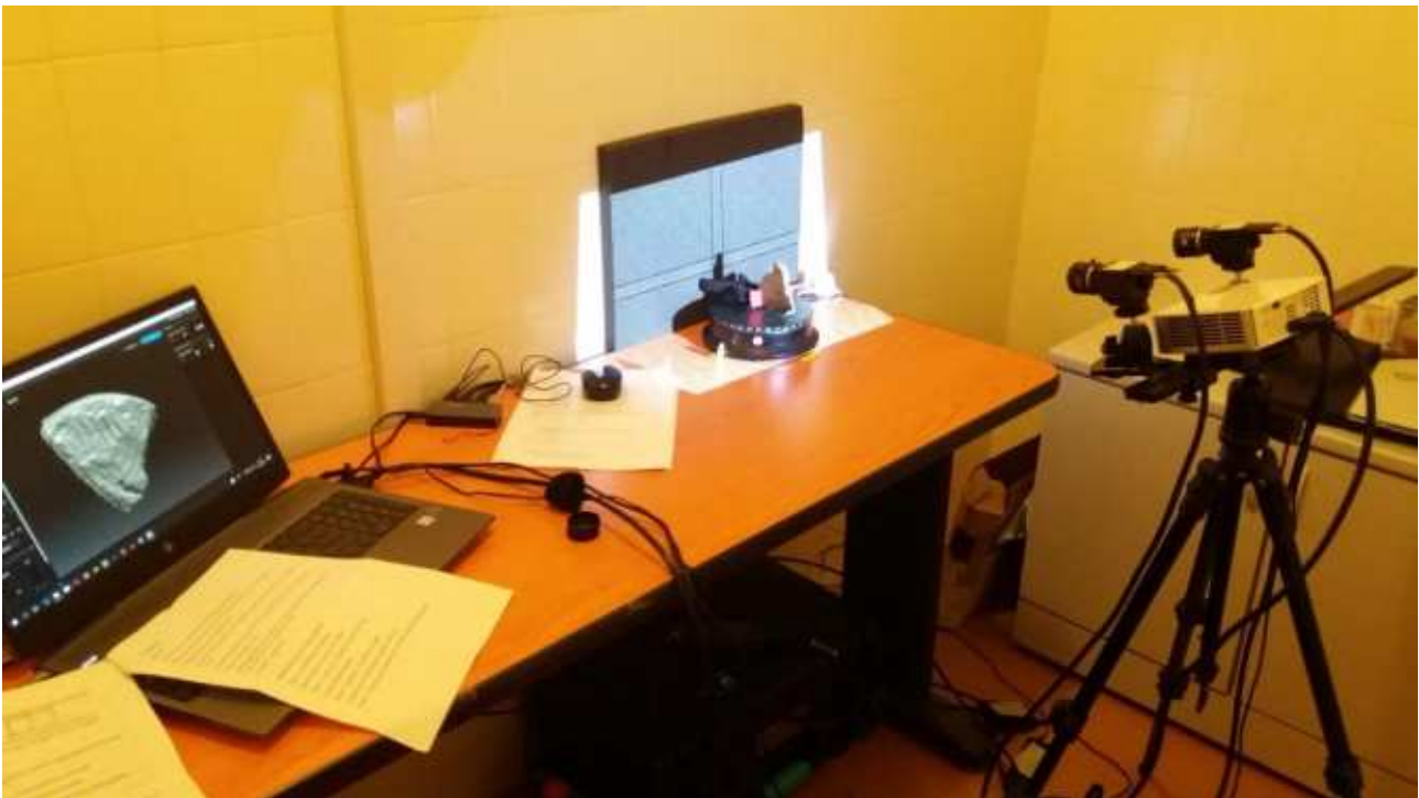
Figura 66: scannerizzazione di un fondo (laboratorio 3D-scan, Università Ca' Foscari)
