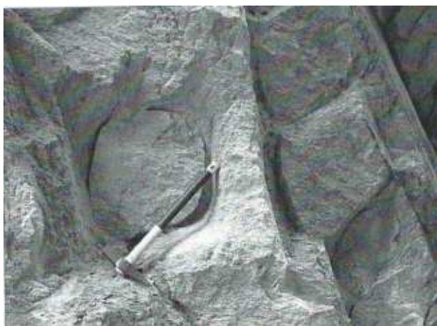
Figura 50: ciapùn sbozzato e asisc a due punte [CAVALLO, GUERRA 2018, p.244]
