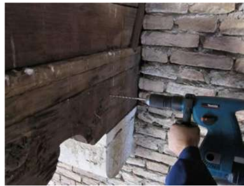
Fig. II.3-4: (a sinistra) una capriata della zona absidale con i riconoscibili tavelloni forati; (a destra) l'esecuzione di una prova per la verifica dello stato di conservazione della testa di uno dei barbacani.
