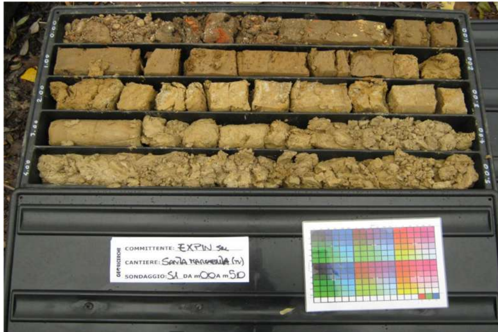
Fig. II.10: la colonna stratigrafica ottenuta dal sondaggio dei primi 5 metri del terreno in prossimità del fronte della Chiesa.
