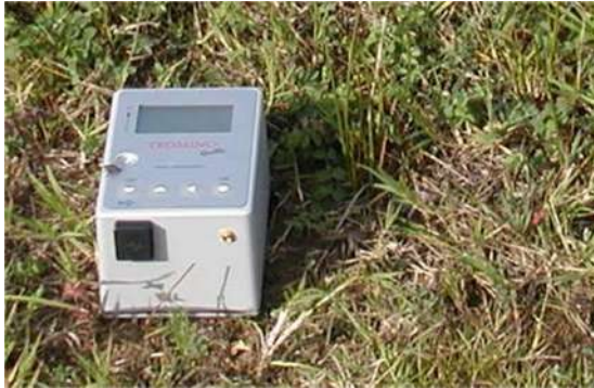
Fig. II.11: un sismografo portatile utilizzato durante le prove FTAN.
