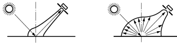
Fig. 11 Riflessione della luce incidente nella direzione speculare (a) e diffusa in tutte le direzioni dello spazio (b)
