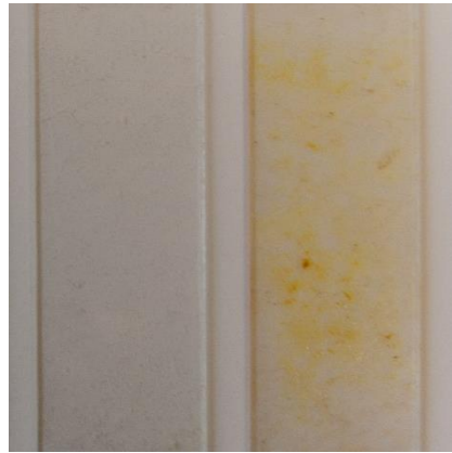
Fig. 14 Campioni di Aquazol®500 invecchiati a 80°C e 120°C fino a 4246 ore
