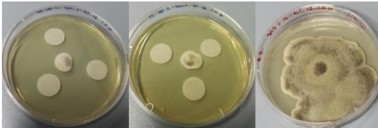
Figura 47: Ife di accrescimento di A. alternata nei campioni EB_SAB-CL_BASIL1_ALT_AB e EB_SAB-CL_BASIL1_ALT_AB, dopo 12 giorni dall'inoculo del micelio. Confronto con il campione di controllo EB_SAB-CL_ALT_AB_BIANCO.
