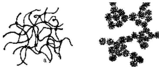
Fig.17: struttura del gel ottenuto in ambiente acido (a) e basico (b).
