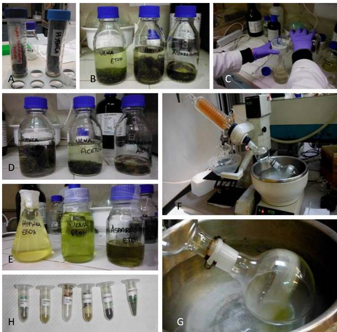
Fig.26: fasi dell'estrazione dei biometaboliti algali: A) campioni liofilizzati; B) campione in EtOH 96%; C) filtrazione; D) campione in acetone; E) estratti finali; F-G) campione in evaporatore rotante; H) estratti finali
