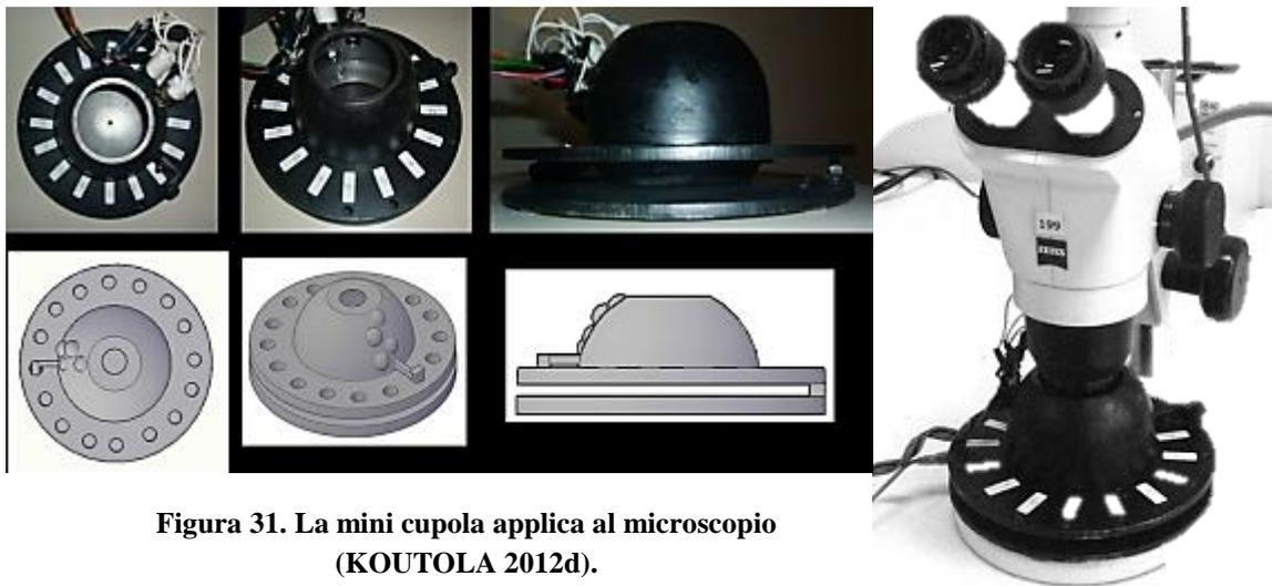
Figura 31. La mini cupola applica al microscopio (KOUTOLA 2012d).
