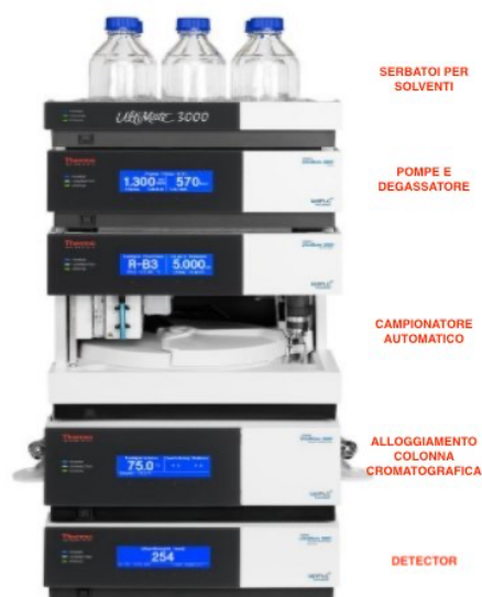
Figura 4: sistema cromatografico Ultimate 3000 HPLC ( Thermo Scientific ).
