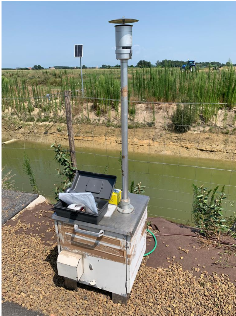
Figura A.1 Campionatore Tecora di PM 10 presso il sito rurale di Roncade (TV).
