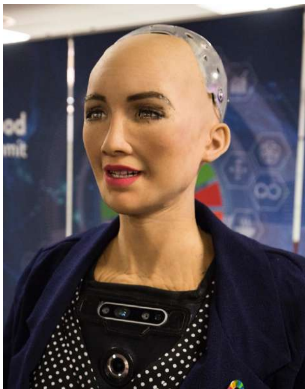
Fig. 3: Sophia, robot umanoide creato da David Hanson di Hanson Robotics. È dotata di una gamma di espressioni emotive e ha la capacità di processare ed elaborare naturali proprietà di linguaggio.
