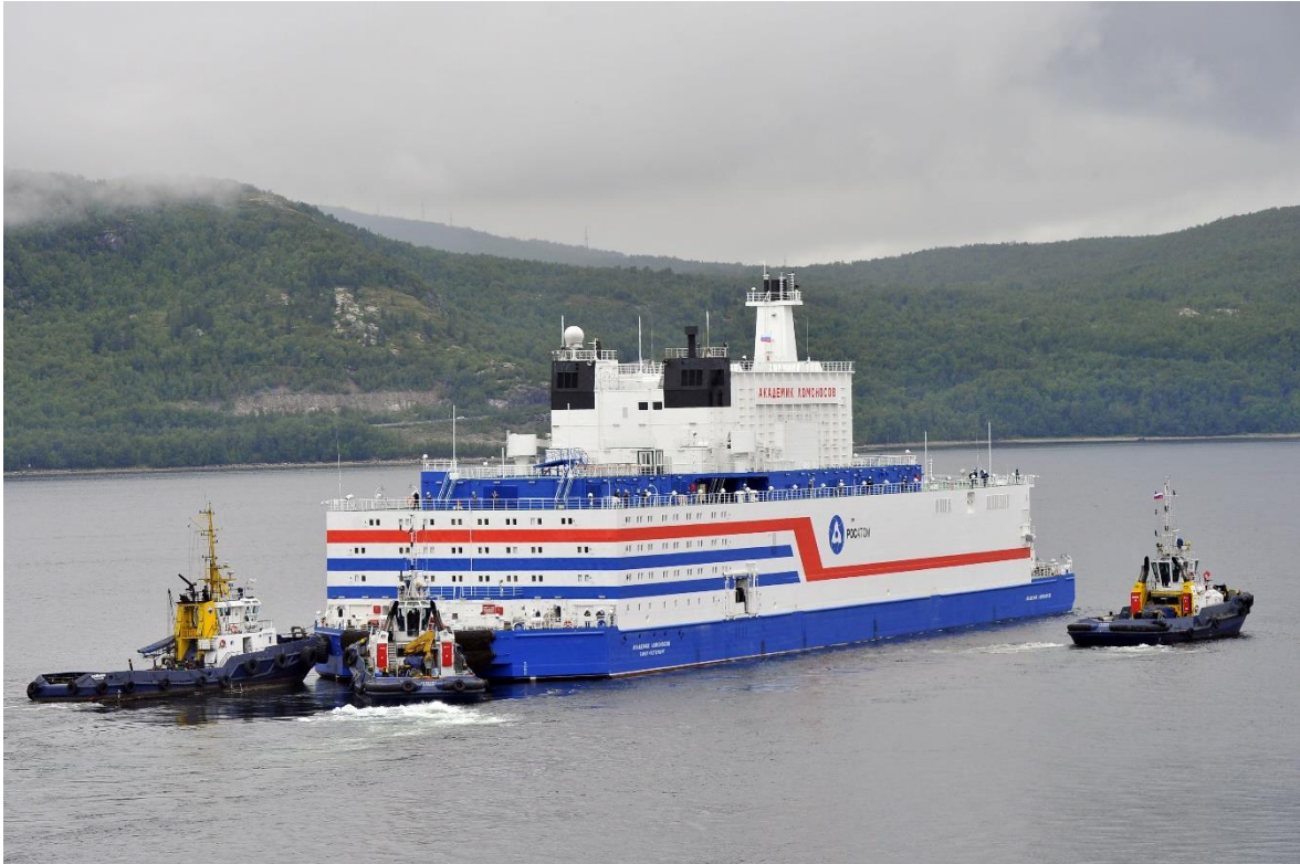
Figura 14. La centrale nucleare galleggiante “Akademik Lomonosov” e i suoi rimorchiatori. L'immagine è tratta dal sito, gestito da ROSATOM, dedicato all'infrastruttura energetica. https://fnpp.info/multimedia/photos .
