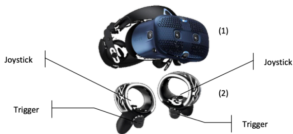
Fig. 6 Visore HMD Vive HTC e i due controller
