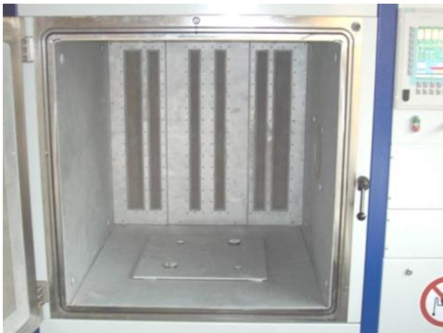
**Figura 31: Configurazione interna della camera di deposizione**
