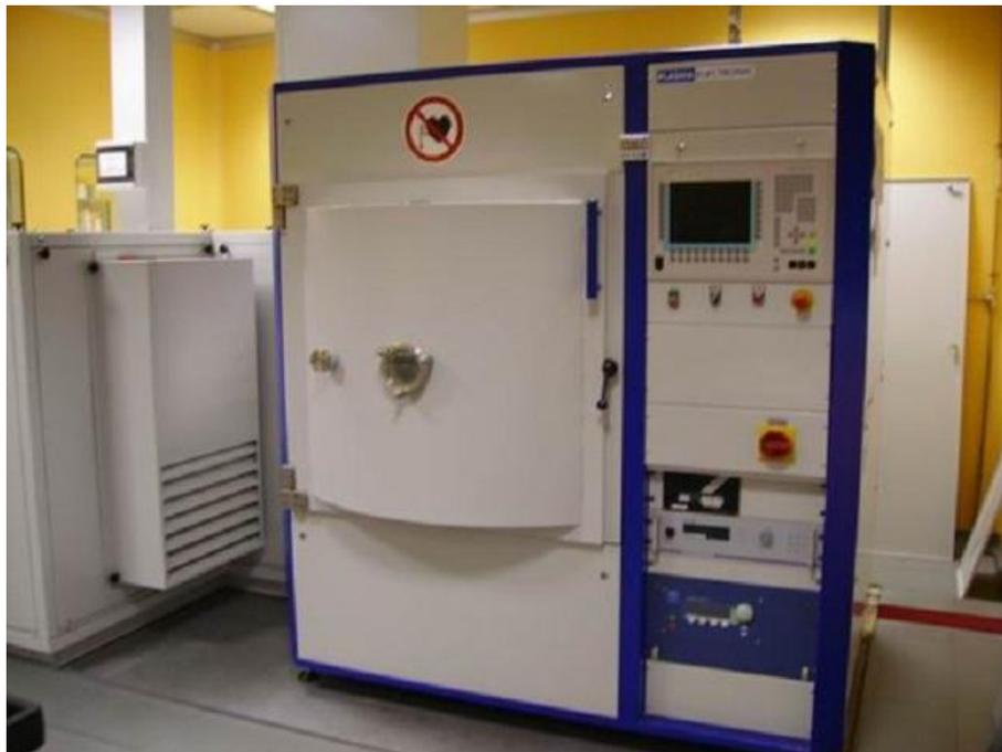
Figura 30: Impianto PECVD utilizzato per le procedure sperimentali
