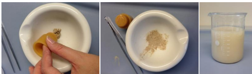
Figura 11: a sinistra e al centro separazione meccanica preliminare della parte di calce dall'aggregato. A destra la frazione di legante così staccato è visibile in sospensione.
