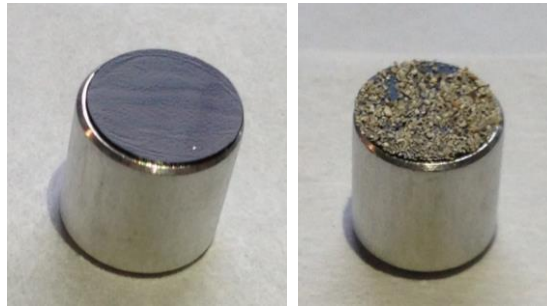
Figura 42: a sinistra portacampione con disco di grafite. A destra portacampioni con campione tal quale adeso al disco di grafite
