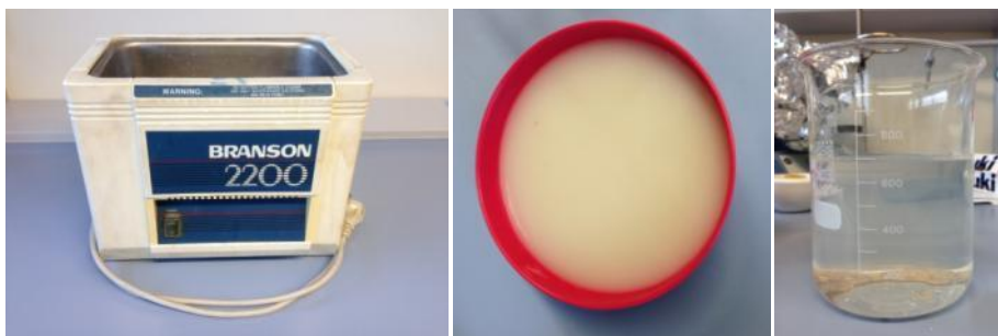
Figura 12: a sinistra vasca a ultrasuoni, al centro contenitore con acqua e calce, a destra becher con aggregato al termine della lavorazione e acqua limpida senza particelle di calce in sospensione
