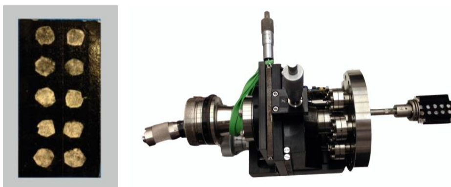
Figura 31: a sinistra nastro di grafite con campioni. A destra parte della camera di misura con il portacampioni in posizione
