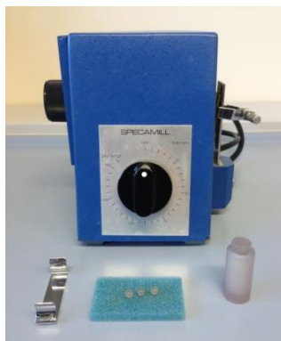
Figura 18: mulino amalgamatore Specac modello Specamill, fialetta di agata, corpi macinanti in agata.
