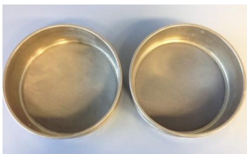
Figura 14: a sinistra setaccio con maglia a 63 \mu\text{m} . A destra setaccio con maglia a 420 \mu\text{m}
