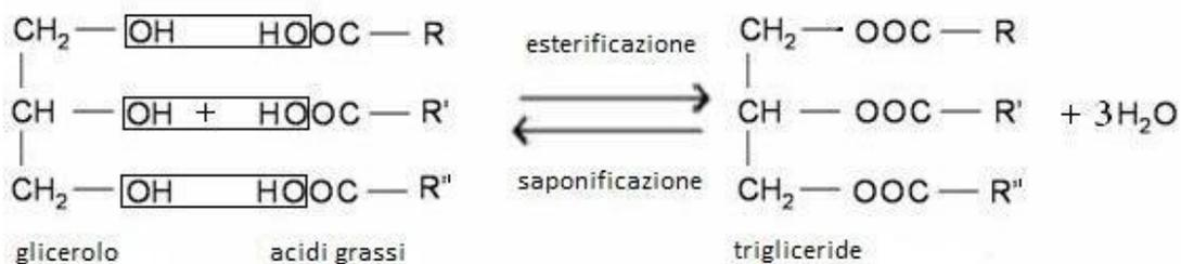
Fig.1.1: Rappresentazione schematica delle reazioni di esterificazione e di saponificazione dei lipidi
