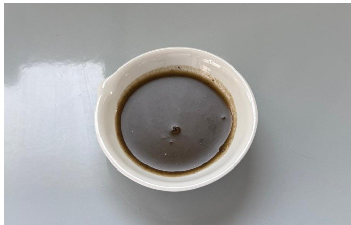
Figura 6. Fango attivo proveniente dall'impianto di Treviso
