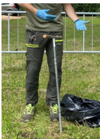
Figura 2.6: Trivella manuale utilizzata per i campionamenti esplorativi di terreno
