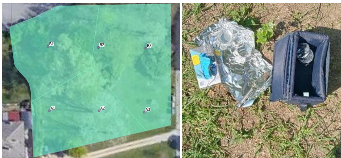
Figura 2.7 e Figura 2.8: Punti di campionamento suddivisi in transetto A e transetto B e materiali utilizzati
