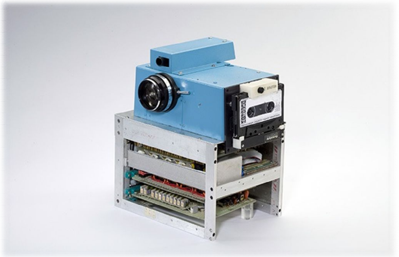
Figura 9 Prima macchina digitale del mondo inventata da Steve Sasson, di 0.01 mega pixel, tempo di esposizione 23 secondi
