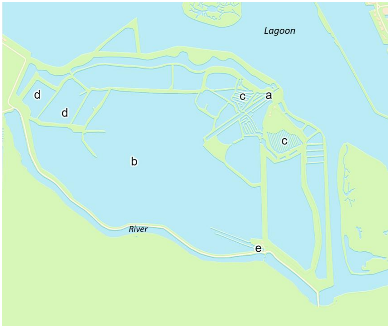
Figura 1. Struttura generale di una valle da pesca. a) chiusa di ingresso acqua salata; b) lago acqua salmastra; c) vasche di sverno e lavoriero; d) lago acqua dolce; e) immissione acqua dolce
