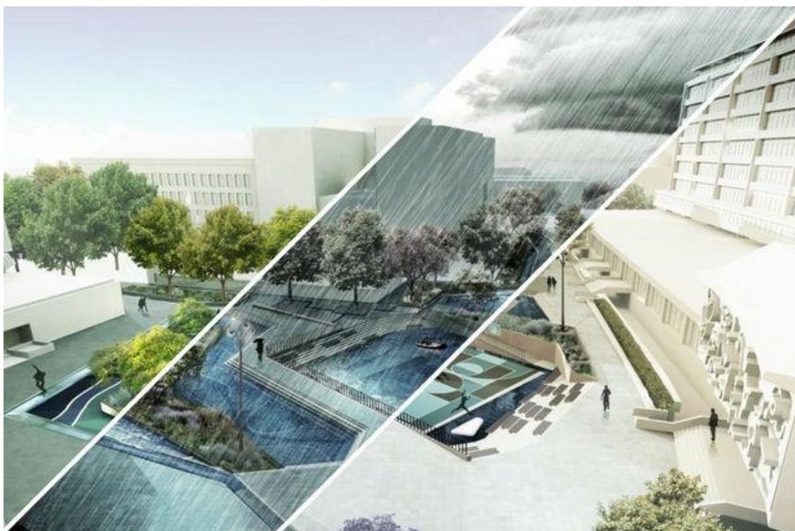
Figura 5. Il progetto in piazza Benthemplein. Si nota la versatilità della piazza, da area ricreativa a contenitore delle acque piovane.
