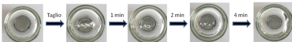
**Figura 2.10** Auto-riparazione del gel polimerico deposto sul fondo di una vial.<sup>23</sup>
