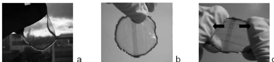
**Figura 2.2** a) Film sottile b) Sovrapposizione dei due lembi per l'auto-riparazione c) Resistenza del film auto-riparato agli stress meccanici<sup>16</sup>
