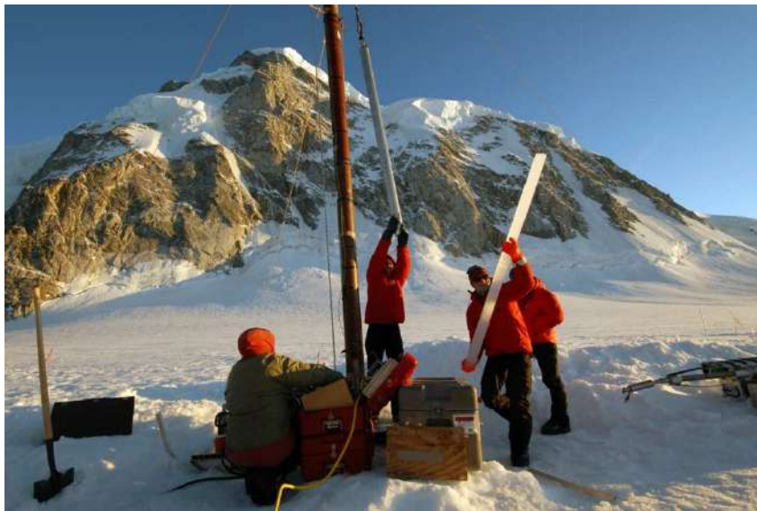
Figura 1.13: Impiego in campo di un carotiere ad azione elettromeccanica (fonte: www.icecores.org ).
