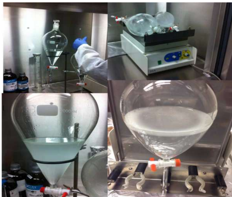
Figura 2.11: Riassunto della fase di estrazione liquido-liquido con imbuto separatore e agitatore meccanico.
