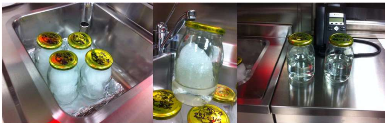
Figura 2.9: Scioglimento dei campioni in Clean-room prima del processo di estrazione.
