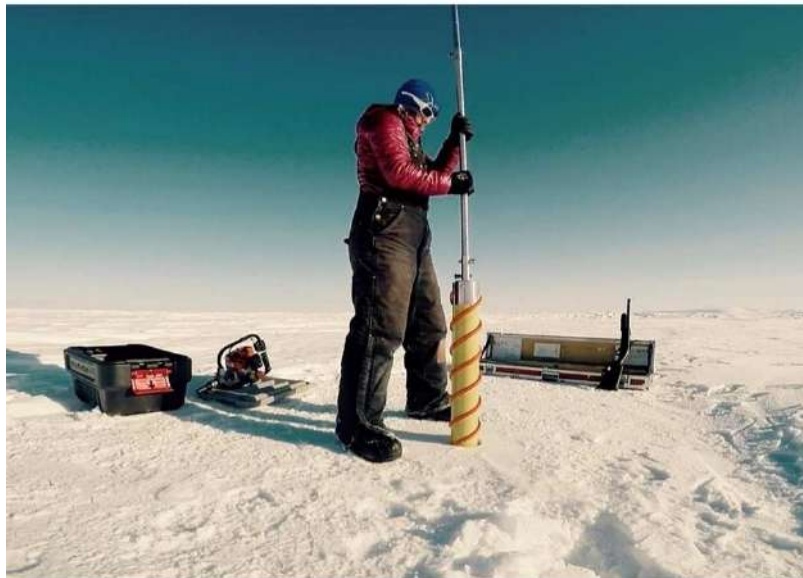
Figura 2.2: Impiego in campo del carotiere Mark II ( Kovacs Enterprise , Roseburg, OR, USA). Tale immagine viene presentata a puro scopo indicativo e non rappresenta la reale fase di campionamento della carota oggetto d'analisi della presente tesi (fonte: https://kovacsicedrillingequipment.com/photo-gallery/ ).
