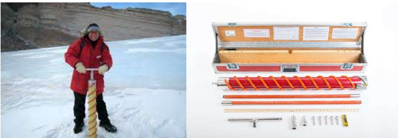
Figura 1.12: Operatore con carotiere meccanico e particolari di dettaglio (fonte: http://artico.itd.cnr.it/index.php/carotatore-e-modello-di-carota-di-ghiaccio e Sciences et al. , 2010).
