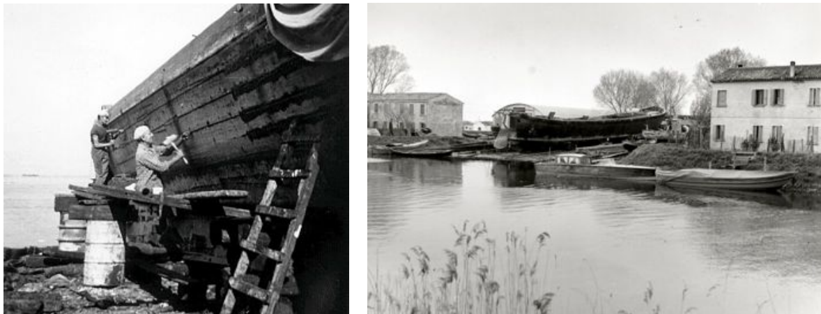
La riparazione di un'imbarcazione e un burcio sulla rampa di uno squero
