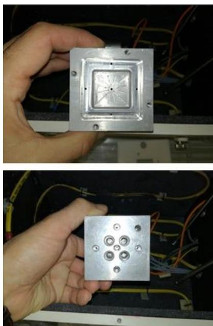
Figura 4.1. Testa di fusione del melter
