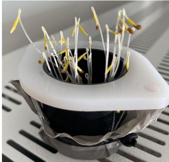
Figura 19: Germogli di *Solanum lycopersicum L.* al termine della fase di germinazione. Si nota la struttura del pot con la rete metallica alla base e l'upper-plate bianco.
