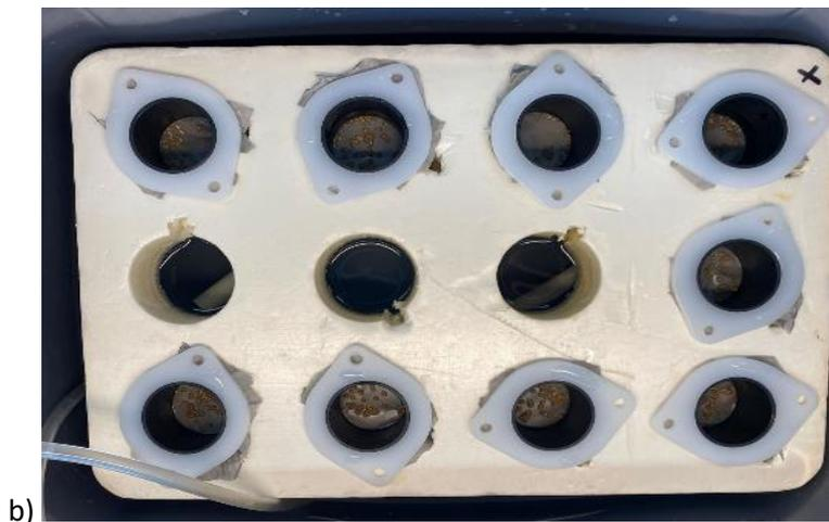
*Figura 18: a) Pot con rete contenente i semi lavati; b) Pot assemblati con rete e upper plate disposti sulla tavola galleggiante di polistirolo.*
