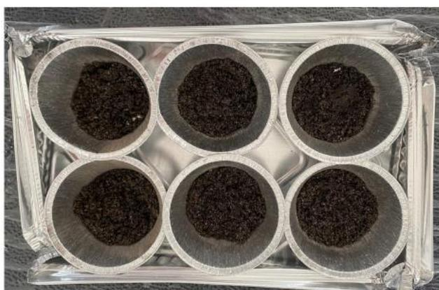
Figura 16: Vasca di alluminio contenente sei terreni standard condizionati al 70% della  $W.H.C.$
