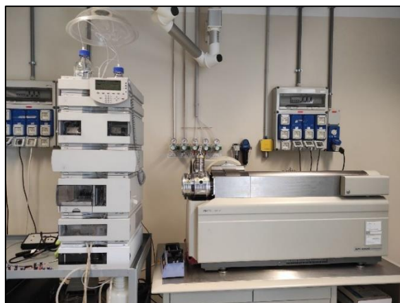
Figura 2.13. Cromatografo liquido ad alte prestazioni (HPLC – High Performance Liquid Chromatograph ) Agilent 1100 Series HPLC Value System (Agilent Technologies Inc., Santa Clara, CA, USA) accoppiato allo spettrometro di massa tandem (MS/MS – tandem Mass Spectrometer ) API 4000™ LC-MS/MS System (Applied Biosystems/MDS SCIEX Pte. Ltd., Toronto, ON, Canada).
