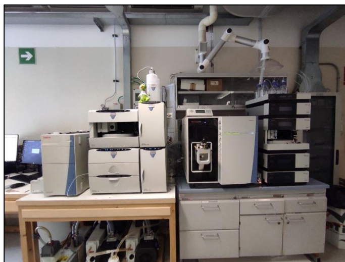
Figura 2.14. Cromatografo a scambio anionico ad alte prestazioni (HPAEC – High Performance Anion Exchange Chromatograph ) Dionex ICS-5000+ Ion Chromatography System accoppiato allo spettrometro di massa tandem a triplo quadrupolo TSQ Altis™ (Thermo Fisher Scientific Dionex Inc. Waltham, MA, USA).
