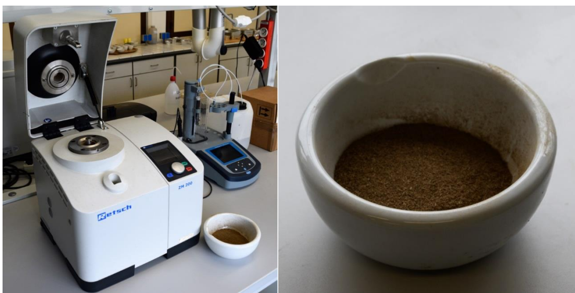
Figura 15: A) Mulino a rotore RETSCH ZM 200 B) Campione di digestato macinato
