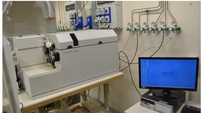
Figura 32_ Spettrometro ICP-MS a quadrupolo Agilent7500I utilizzato in questo lavoro.
