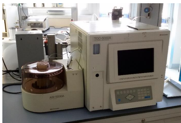
Figura 50_ Strumento Shimadzu TOC-5050 utilizzato nel presente lavoro per l'analisi del TIC.
