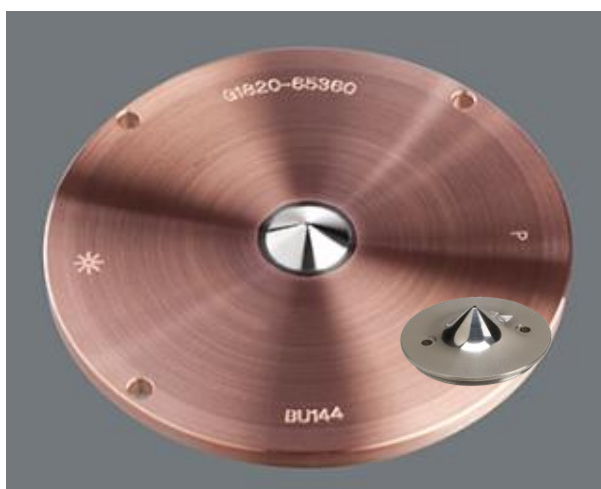
Figura 41_Esempio di Sampler Cone e Skimmer Cone in platino [adattato da (Salvagio Manta, Tamburino, & Sprovieri, 2010)].
