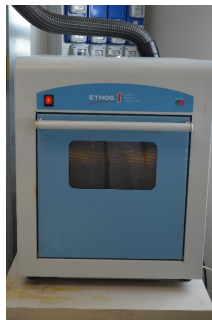
Figura 31_ Digestore microonde ad alta pressione Milestone®1600 utilizzato in questo studio.
