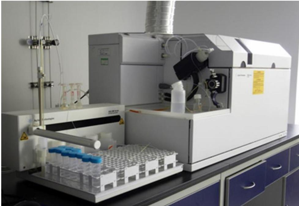
*Figura 8: Spettrometro di massa al plasma accoppiato induttivamente (ICP-MS)*
