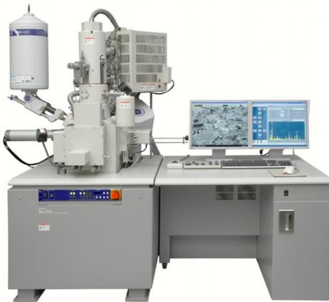
*Figura 5: Microscopio elettronico a scansione (SEM)*
