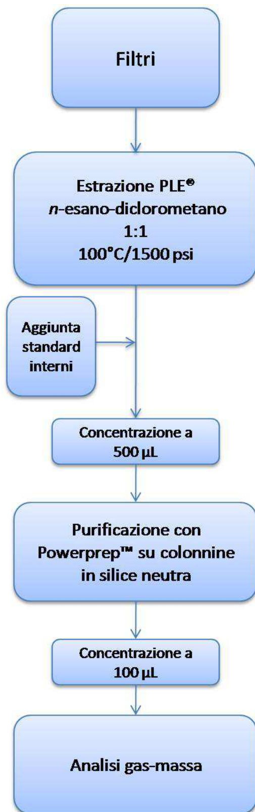
Figura 28: Schema della metodica messa a punto per il materiale particolato.
