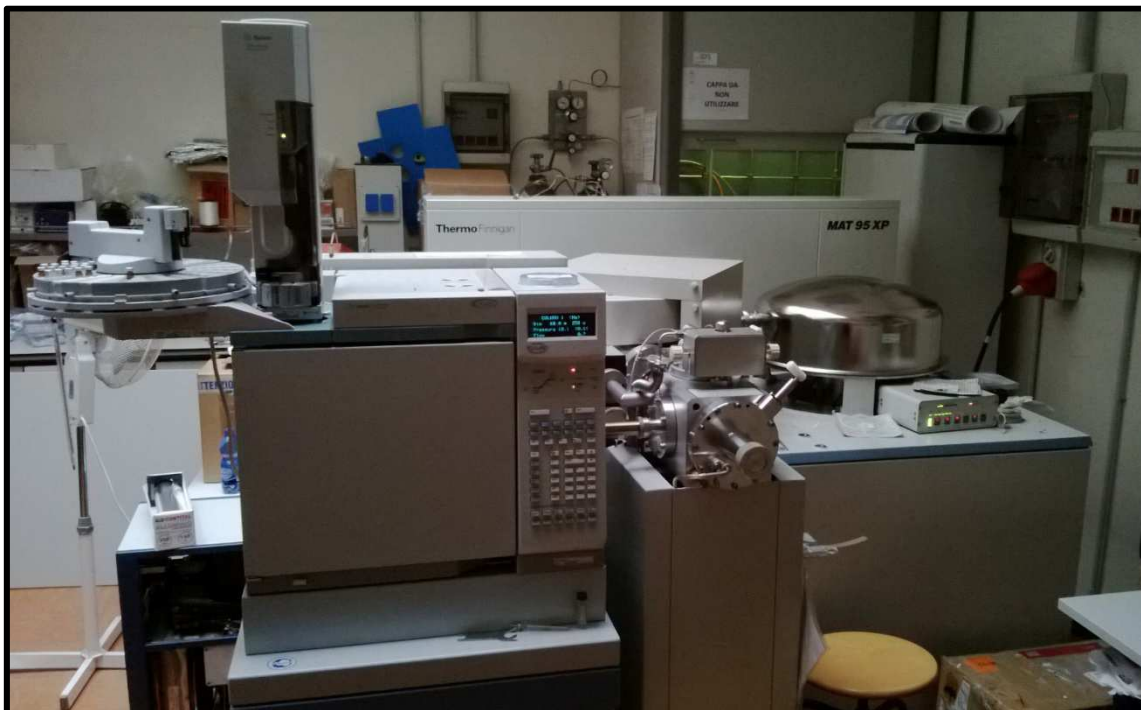
Figura 20: Gascromatografo Hewlett Packard-Agilent 6890 accoppiato a spettrometro di massa ad alta risoluzione Thermo Finnigan MAT 95 XP .
