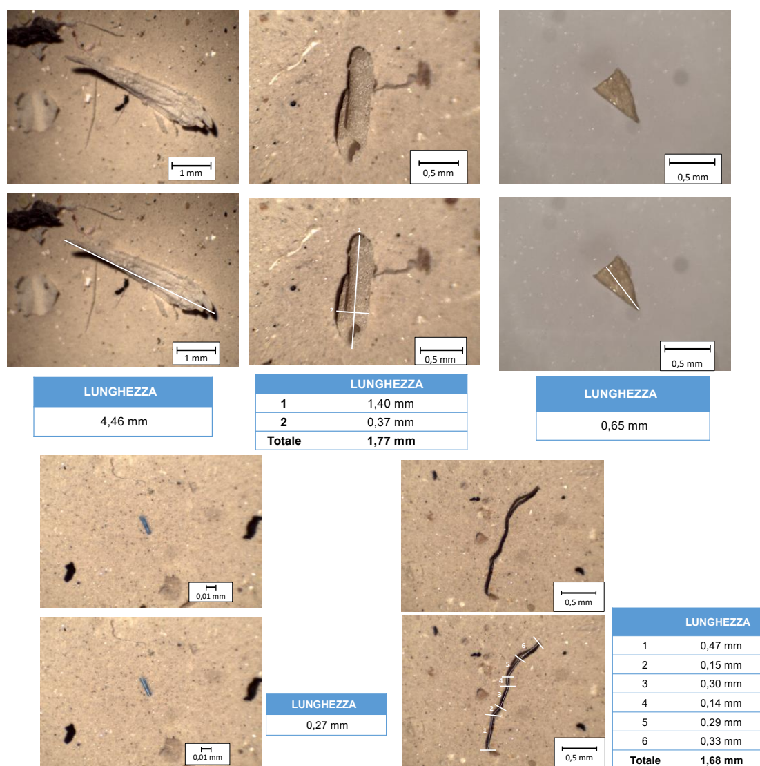
Figura 3.6. Microplastiche individuate al microscopio ottico nel campione di digestato essiccato.
