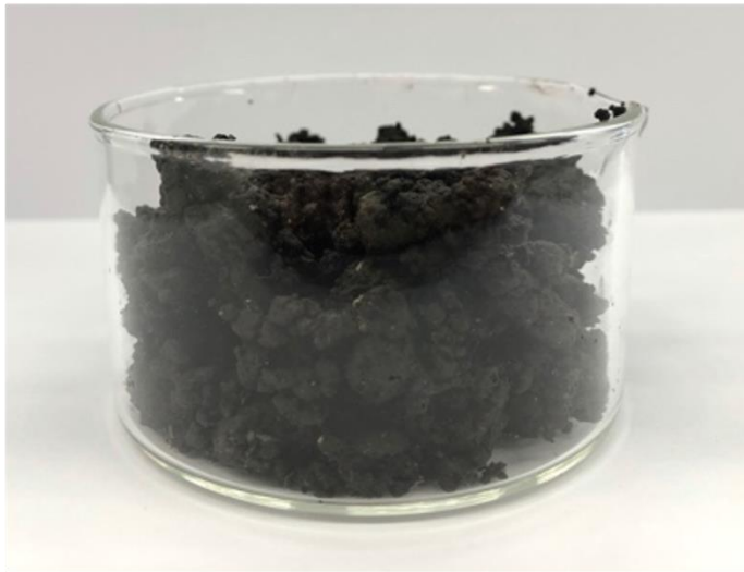
Figura 2.3. Digestato disidratato tramite centrifugazione.
