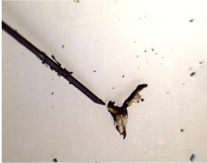
Figura 2.18. The Hot Needle Test utilizzato per verificare la natura dei frammenti nel filtro.
