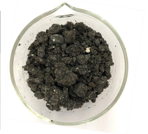
Figura 2.4. Digestato essiccato in serra (bioessiccazione).
