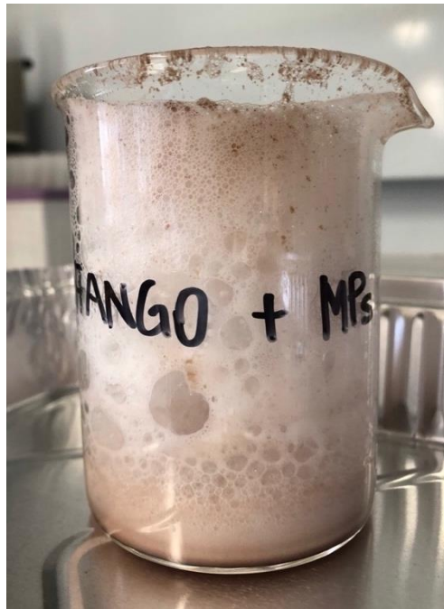
Figura 2.10. Reazione sviluppata da 100 g di fango e 100 ml di H_2O_2 .
