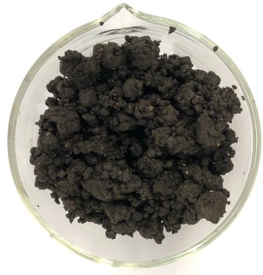
Figura 2.3. Digestato disidratato tramite centrifugazione.
