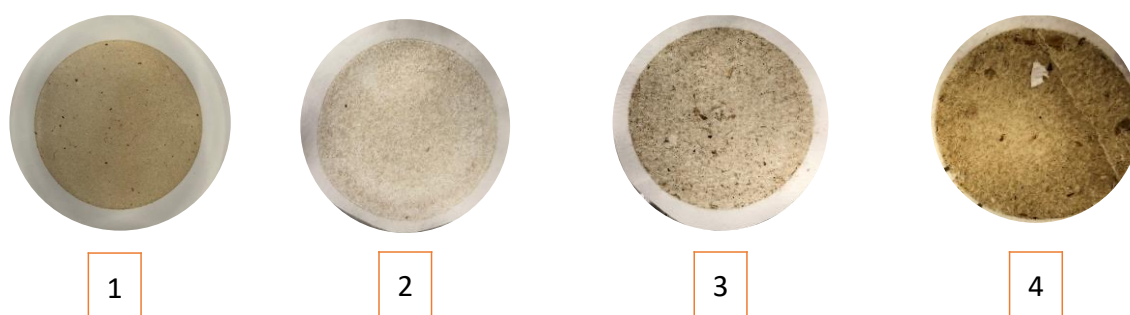
Figura 2.17. Filtri a membrana in acetato di cellulosa ottenuti mediante filtrazione del surnatante con l'utilizzo di una soluzione salina di \text{ZnCl}_2 .
