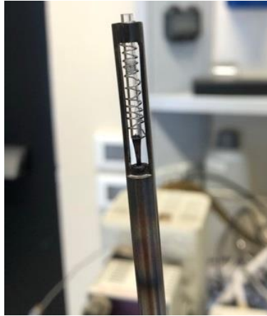
Figura 2.21. Sonda a filamento del pirolizzato. All'interno è posizionato il tubicino di quarzo dove viene inserito il campione da analizzare.
