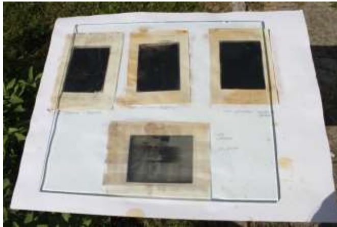
Figura 199: Esposizione dei supporti cartacei preparati con i rispettivi negativi alla luce solare. Tempo di esposizione: 30 minuti.
