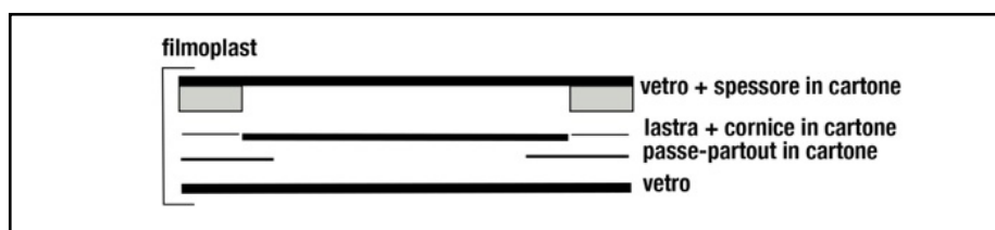
Figura 2.2: Schema di montaggio conservativo temporaneo.
