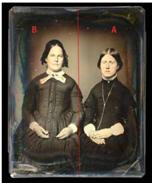
Figura 3.11: Zone di trattamento con plasma atmosferico sul lastra A8.
