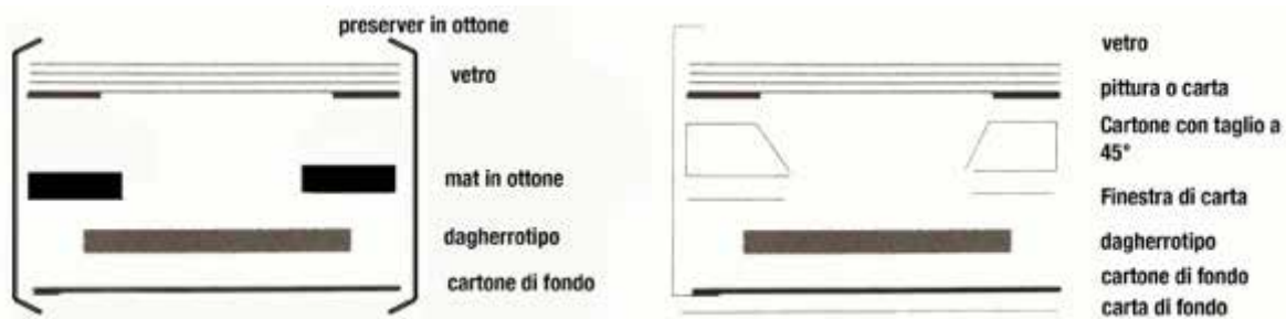
Figura 1.11: a) sandwich tipico del montaggio americano che viene poi inserito nel contenitore in legno e cuoio, b) montaggio europeo.
