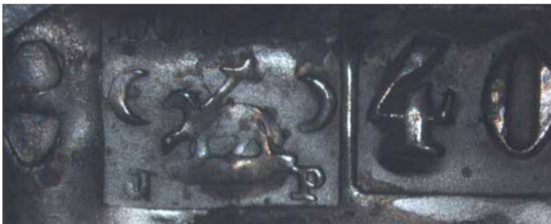
Figura 1.4: Ingrandimento con microscopio metallografico a 12X di punzone presente su lastra A2. Asterisco JP doublé, massa 40. Fabbricante di lastre probabilmente francese. (Chiesa G., 2014)
