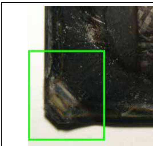
(a) Deformazione dell'angolo della lastra
