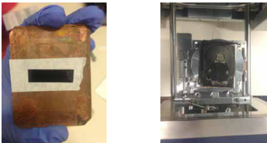
Figura 2.5: a) Applicazione di nastro adesivo conduttore per l'ancoraggio della lastra al porta campioni. b) posizionamento della lastra A5 sul porta campioni del SEM.
