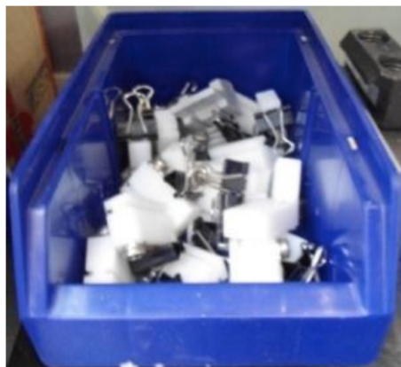
Figura 11 – Cassetta piena che indica il termine della lavorazione dei componenti
