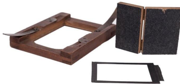
Figura 4. Telaio o torchio per processo ad annerimento diretto
