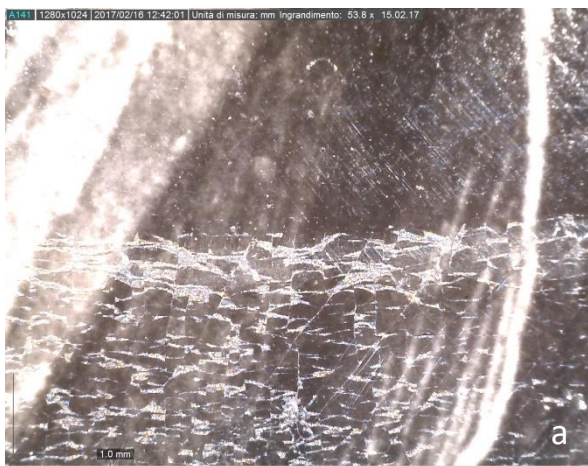
Figura 16. Fotografia con microscopio digitale a 50x del campione C7, in luce diffusa (a) e UV (b).
