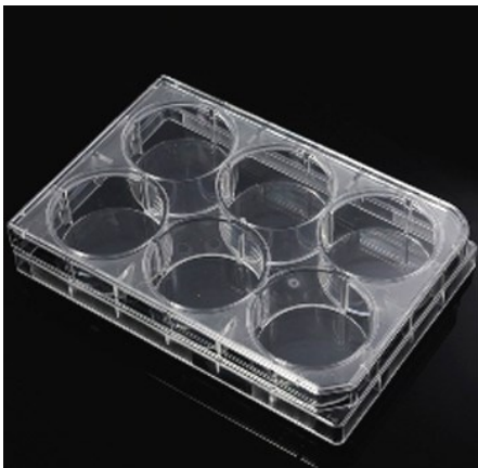
Figura 7 Piastra da sei pozzetti
