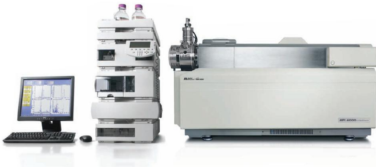
fig. 4.2 Il sistema HPLC-MS/MS usato per le analisi
