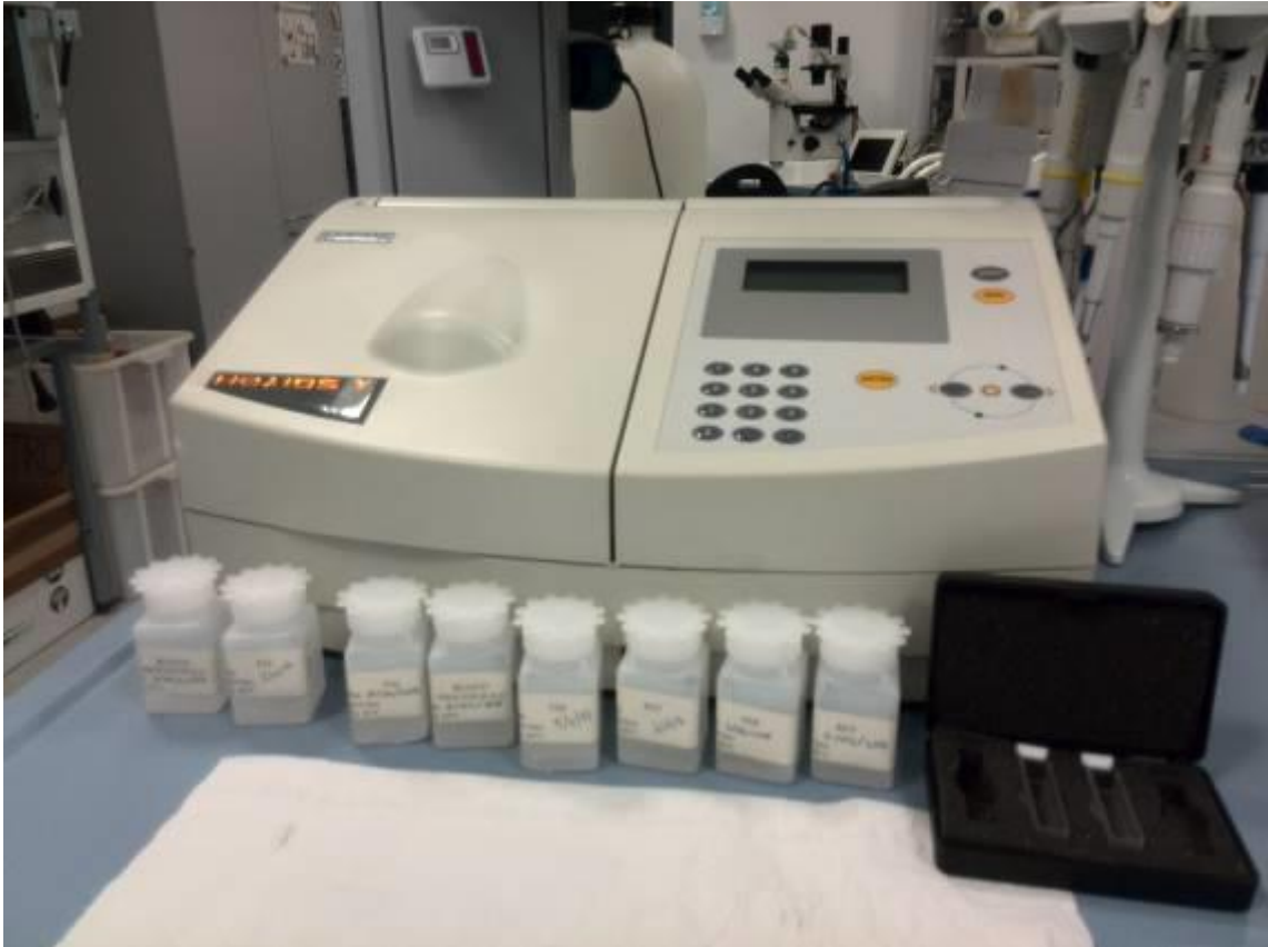
Figura 13 Campioni di lisciviato pronti per la preparazione delle piastre e spettrofotometro tramite il quale si andrà a misurare l'assorbanza.
