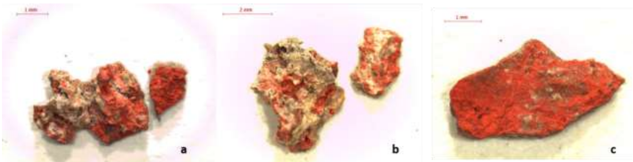
Figura 4.6 Fotografia allo stereomicroscopio del campione X1 suddiviso nei frammenti diafasi (a) ed epifisi (b) e del campione X3-1 (c).
