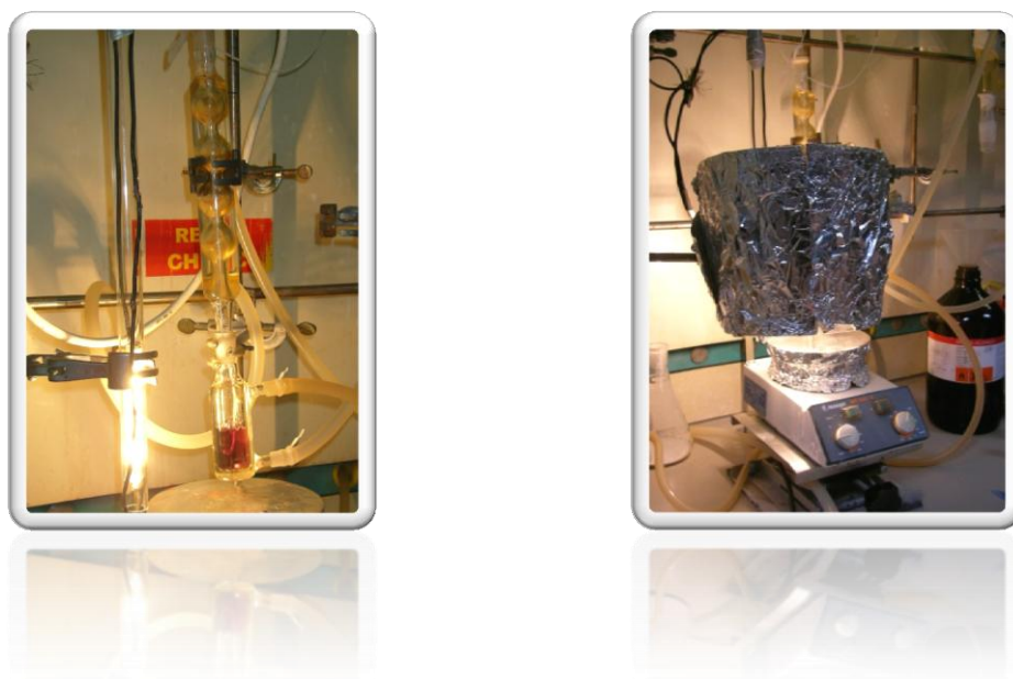
Figura 3.1: Apparato di fotoossigenazione
